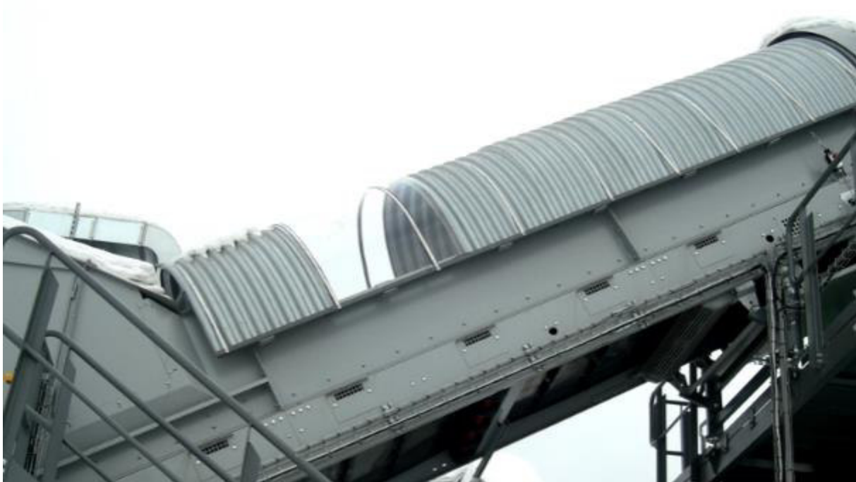
Rysunek 25: Przykładowy taśmociąg osadu wysuszonego.
