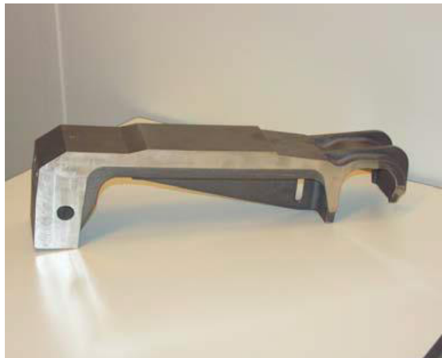
Rysunek 10: Pojedyncza rusztowina - ruszt chłodzony powietrzem.
